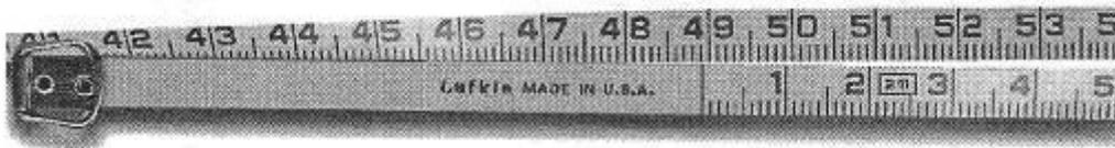
Figura 2B. Leyendo la cinta: encuadre la marca cero con el tope de la escala: aquí se lee 48.9 cm.
